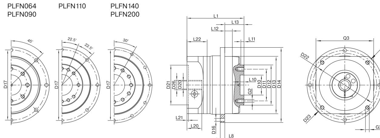
PLFN090 ile aynı özelliklerde / 1-kademeli / fl anş bağlantılı çıkış mili / 19 mm sıkma sistemi / motor bağlantılı – 2 parçalı – dairesel universal flanş yapısı / B5 motor flanş tipi
